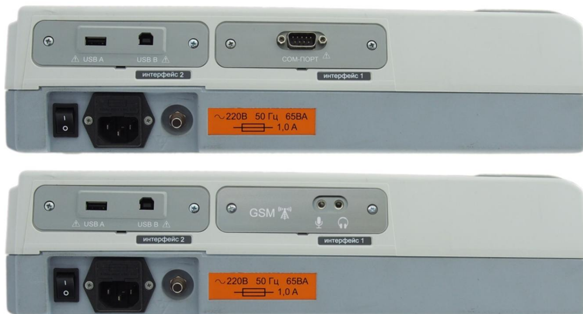
Рисунок 5.3 – Задняя панель ЭК с разными вариантами интерфейсов
